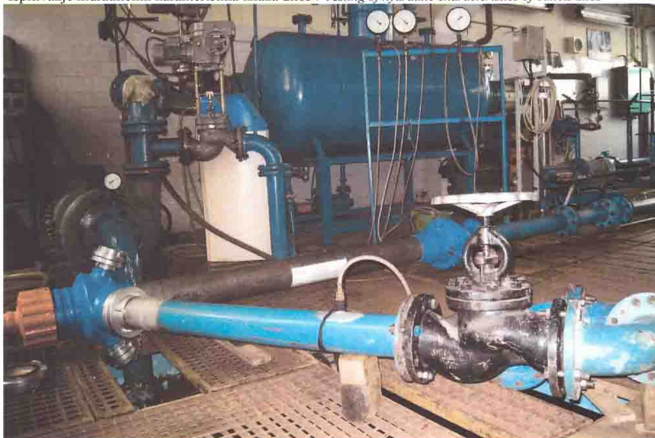
Ispitivanje hidrauličnih karakteristika izlaza 1x100 / Testing of hydraulic characteristics of outlet 1x100
