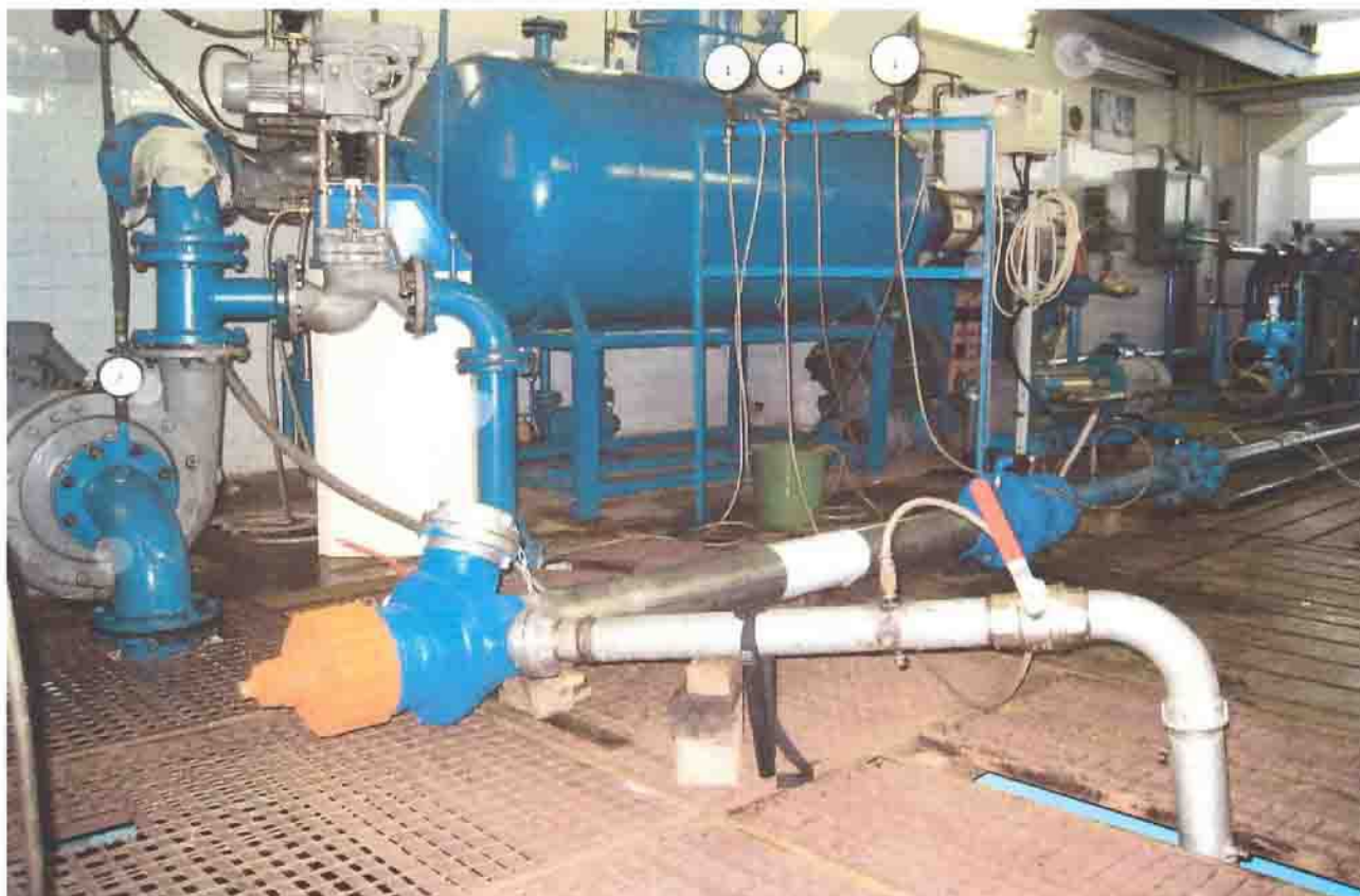
Ispitivanje hidrauličnih karakteristika izlaza 2x65 / Testing of hydraulic characteristics of outlets 2x65
